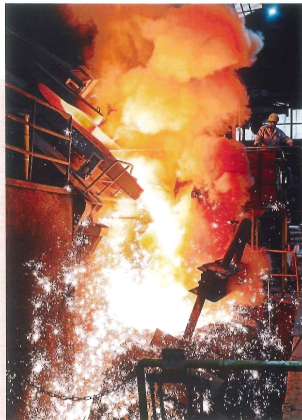
高温で溶解した鉄を取り鍋に注ぐ。オレンジ色にく溶湯がその後、鋳型に注がれ、大型鋳物になる。いずれも姫路市大津区、虹技(撮影・風斗雅博)
